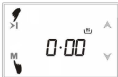
При одновременном нажатии кнопок «>|» и «М» будет осуществлен вход в ручной режим. Все предыдущие программы готовки будут отменены.
