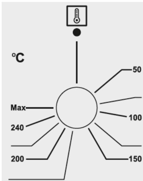
**Термостат:** Устанавливает температуру приготовления пищи, помещенной в духовку. Вы можете установить желаемую температуру, повернув ручку термостата. Для правильного подбора температуры готовки вы можете воспользоваться нашей таблицей «Выпечки и Жарки». В моделях с утапливаемыми ручками, выбранной температуре соответствует черточка слева от соответствующего значения.
