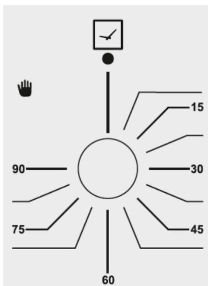
**Механический таймер:** для включения духовки при выборе режима готовки и желаемой температуры Вам также нужно отрегулировать время. В противном случае духовка не заработает. По истечении времени таймер отключает нагреватели и предупреждает Вас сигналом. При повороте регулятора в область больше 90° устанавливается ручной режим.
