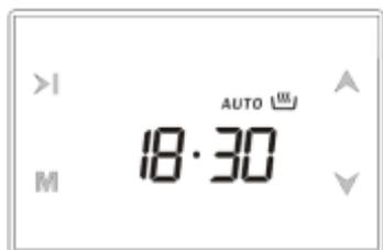
Вы запрограммировали свой духовой шкаф на приготовление пищи в течение 2 часов и 15 минут. Пожалуйста, не забудьте привести другие переключатели вашего духового шкафа в соответствующее положение с необходимым функциональным и температурным режимом.
