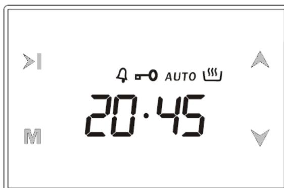
Сенсорный таймер - это электронный таймер, который позволяет устанавливать время приготовления еды и время отсрочки запуска. Его также можно использовать в качестве будильника, в этом режиме духовка включаться не будет, а по истечении установленного времени таймер оповестит Вас звуковым сигналом.
