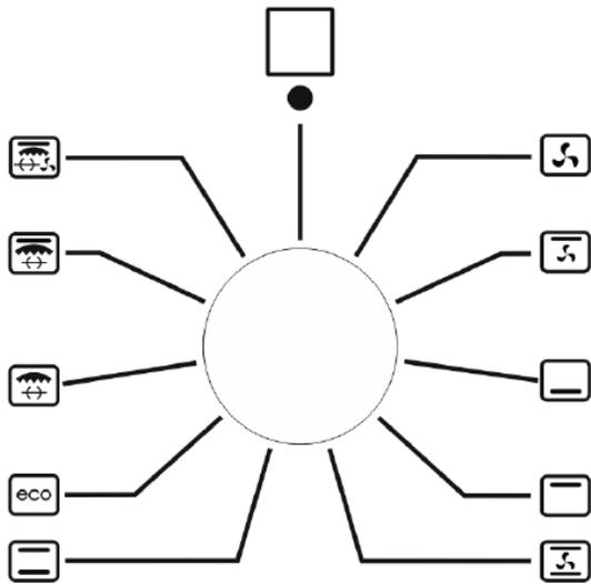
**Переключатель функций:** Предназначен для установки необходимой программы готовки. Типы программ и функций указаны в разделе «Функции духовки». У различных моделей духовок количество нагревателей и функций может различаться. У духовок с утапливаемыми ручками изображения функций нанесены на сами ручки. Функции гриля с вертелом предусматриваются только для моделей НОЕ-273, - 275.
