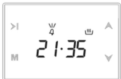
По истечении запрограммированного периода времени прозвучит звуковой сигнал. Нажатие любой кнопки отменяет звуковой сигнал.
