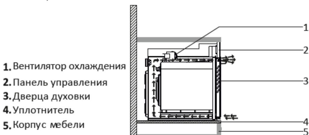
**Вентилятор охлаждения** должен вытягивать избыточный пар и предотвращать перегрев наружных поверхностей духовки во время работы. Это является необходимым условием для улучшения работы прибора и приготовления блюд. Охлаждающий вентилятор должен продолжать работу после окончания приготовления. Вентилятор автоматически останавливается после завершения охлаждения. Установщик должен оставить зазор за корпусом, где вы разместите духовку для
